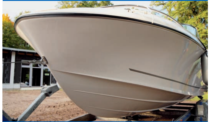
Hohes Freibord, unten scharf, oben füllig – die norwegische Konstruktion überzeugte auch in der Welle.
